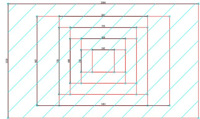
本製品は、上図に示すVESA規格の取り付けピッチをはじめとして、斜線の取付け範囲(862x512)のエリアに入るさまざまなディスプレイの取り付けに対応しています。
