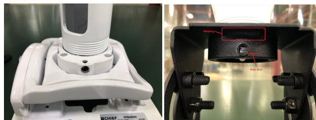
【写真】 ネジの嵌合の状態の例
