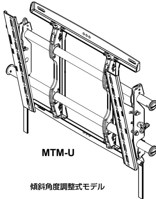
傾斜角度調整式モデル
