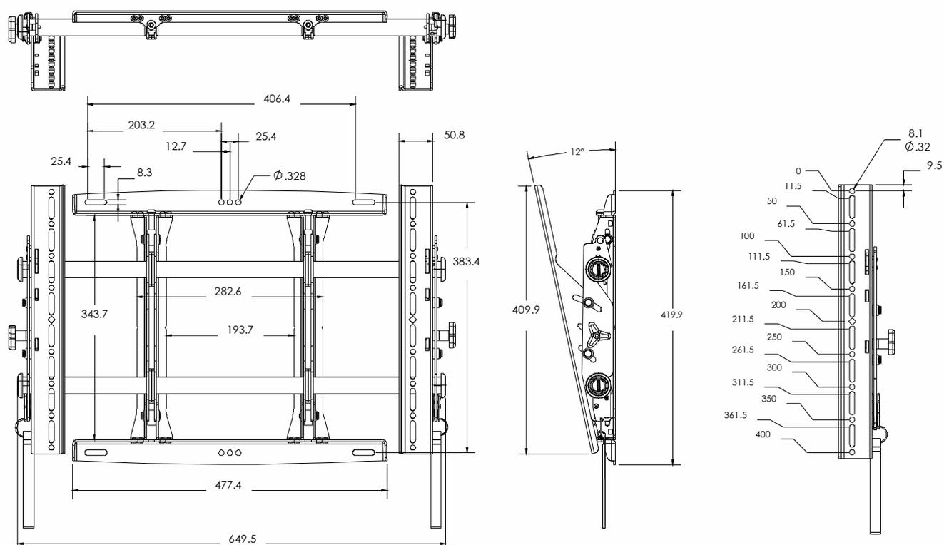
壁面固定は、壁補強位置に合わせて長穴の範囲で設置可能ですので、左右の位置調整が可能です。
