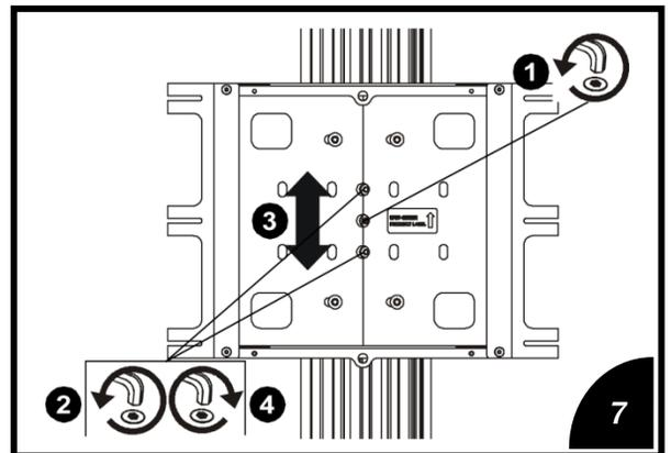
①PCホルダーの高さ調整を行う場合、サイドパネルを取り外したあと、①で示した固定ビスをゆるめます。
