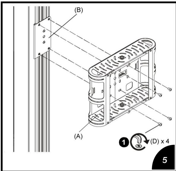
①固定ビス(D)を4つ使用してPCホルダーをアダプターブラケットに固定します。
