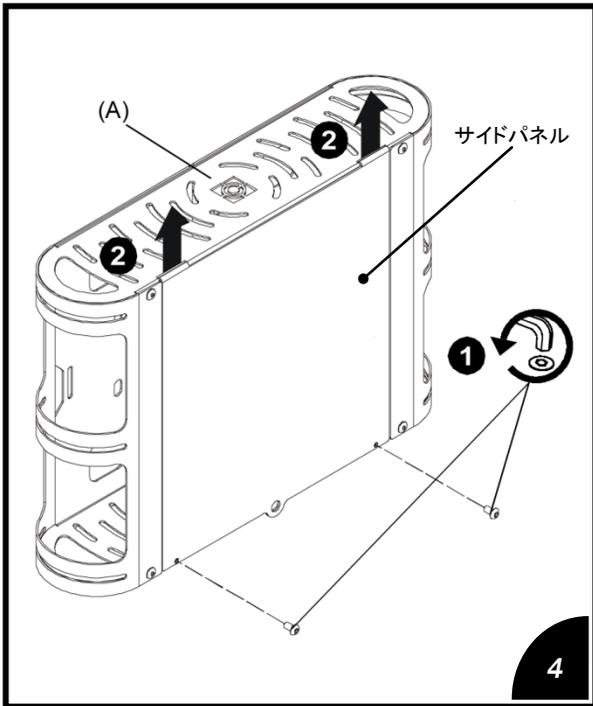
①2つのビスを外して、PCホルダーから(A)からサイドパネルを取り外します。
