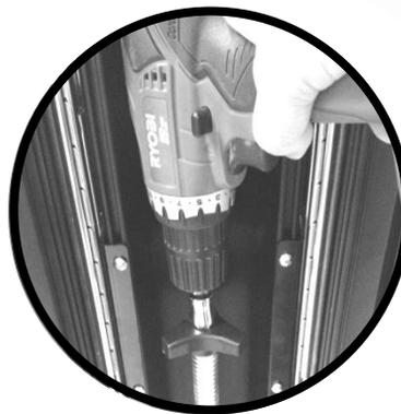
高さ調整ノブの上から電動ドリルを差し込むようにして、調整ノブをまわします。
